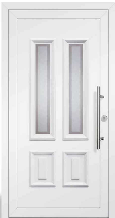
M81231 | Einsatzfüllung | Weiß ähnlich RAL 9016 | Lichtausschnitt: 2x 174 mm x 949 mm | Ornamentrahmen beidseitig | Glas sandgestrahlt mit klarem umlaufenden Rand | Stangengriff S_1020, Edelstahl matt, 600 mm | Rundrosette Edelstahl matt Ausstattung in Abbildung: FK0 GG0 DG0
