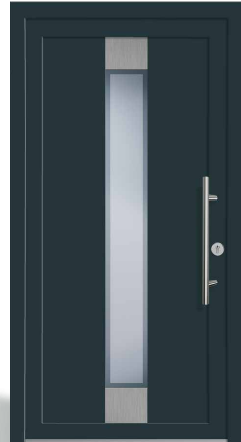
M01182 | Einsatzfüllung | Anthrazitgrau foliert genarbt | Lichtausschnitt: 200 mm x 1520 mm | Applikation in Edelstahloptik außen | Glas sandgestrahlt mit klarem umlaufenden Rand | Stangengriff S_1020, Edelstahl matt, 600 mm | Rundrosette Edelstahl matt Ausstattung in Abbildung: FK1 GG0 DG0 Modell erhältlich als: KA RC2
