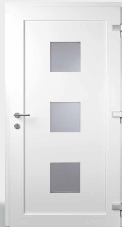
Innenansicht M04303 | Einsatzfüllung | Weiß ähnlich RAL 9016 | Lichtausschnitt: 3 x 280 mm x 280 mm | beidseitig rahmenlos | Innendrucker D_0060 auf Rundrosette, Edelstahl matt | 3 zweiteilige Türbänder, dreidimensional verstellbar, silberfarben
