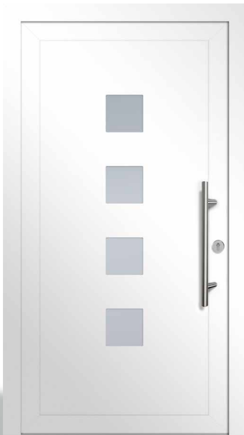
M04400 | Einsatzfüllung | Weiß ähnlich RAL 9016 | Lichtausschnitt: 4 x 206 mm x 206 mm | beidseitig rahmenlos | Ornamentglas Satinato | Stangengriff S_1020, Edelstahl matt, 600 mm | Rundrosette Edelstahl matt Ausstattung in Abbildung: FK0 GG3 OG1 Modell erhältlich als: KA RC2
