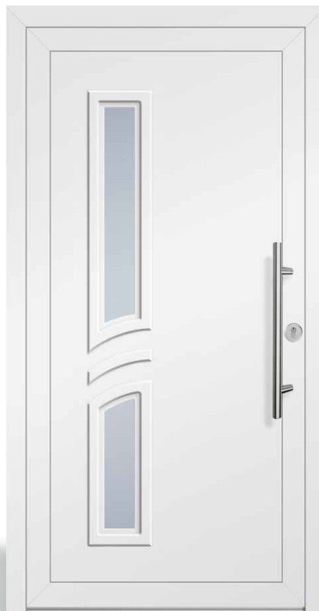
M01281 | Einsatzfüllung | Weiß ähnlich RAL 9016 | Lichtausschnitt: 2x 98 mm x 365/700 mm | Ornament- rahmen beidseitig | Ornamentglas Satinato | Stangengriff S_1020, Edelstahl matt, 600 mm | Rundrosette Edelstahl matt Ausstattung in Abbildung: FK0 GG0 OG1
