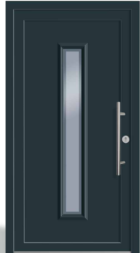
M01141 | Einsatzfüllung | Anthrazitgrau foliert genarbt | Lichtausschnitt: 174 mm x 1424 mm | Ornamentrahmen beidseitig | Glas sandgestrahlt mit klarem umlaufenden Rand | Stangengriff S_1020, Edelstahl matt, 600 mm | Rundrosette Edelstahl matt Ausstattung in Abbildung: FK1 GG0 DG0
