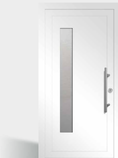
M01230B | Einsatzfüllung | Weiß ähnlich RAL 9016 | Lichtausschnitt bandseitig: 170 mm x 1400 mm | beidseitig rahmenlos | Ornamentglas Satinato | Stangengriff S_1020, Edelstahl matt, 600 mm | Rundrosette Edelstahl matt Ausstattung in Abb.: FK0 GG0 OG1 Modell erhältlich als: KA RC2
