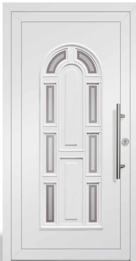
M08811 | Einsatzfüllung | Weiß ähnlich RAL 9016 | Lichtausschnitt: 6x 105 mm x 350 mm / 2x 102 mm x 200 mm | Ornamentrahmen beidseitig | Glas sandgestrahlt mit klarem umlaufenden Rand | Stangengriff S_1020, Edelstahl matt, 600 mm | Rundrosette Edelstahl matt Ausstattung in Abbildung: FK0 GG0 DG0
