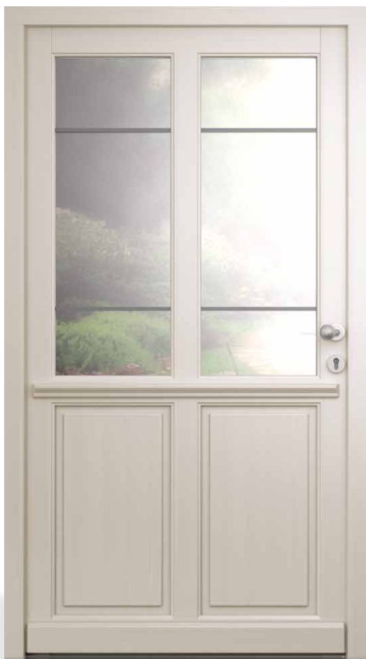
AH 94309 • Rahmenkonstruktion • Holzart Kiefer • Perlweiß RAL 1013 • Karniesprofil am Flügel • glasteilende Sprossen 98mm und 78mm • Verglasung mit Bleisprossen • Brüstungsplatten außen mit flachen Kassetten • Zierprofil außen • S2150 Edelstahl-Knauf
